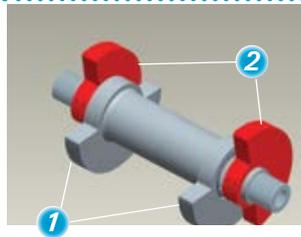
Cuando la excéntrica regulable (2) gira a la posición que se muestra en la figura anterior, la amplitud es del 50%.
