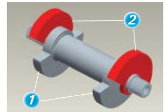
Cuando la excéntrica regulable (2) gira a la posición que se muestra en la figura anterior, la amplitud es del 0%.
