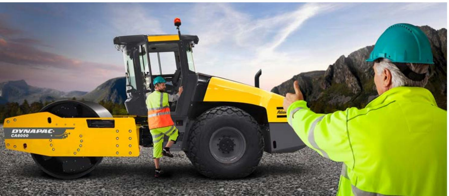
*Herramientas: Un rodillo de tierras CA de quinta generación de Dynapac equipado con optimizador de compactación, medidor de compactación y analizador de compactación con GPS (opcional).*
