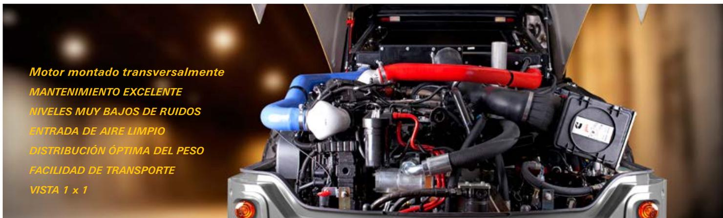
**Motor montado transversalmente**
